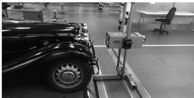
Předepsanému nastavení regloskopu předchází kontrola tlaku v pneu a vystoupení řidiče z vozu. Poklice jsou již nasazeny.
